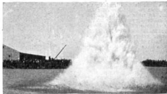
VOLADURA DE UN TORPEDO CON 10 KILOS DE ALGODÓN-PÓLVORA
