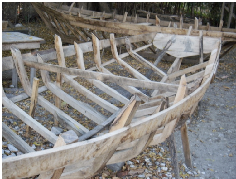
Detalles de cuadernas y primeras tracas
